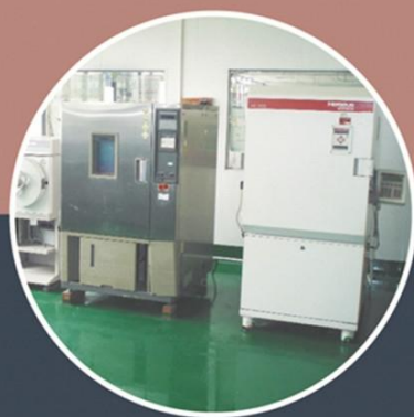
电容器/滤波器产品测试中心 环境试验设备 （引进德国，日本的环境实验设备） Environmental test equipments for capacitor product test center (imported environmental laboratory equipments from Germany and Japan)
